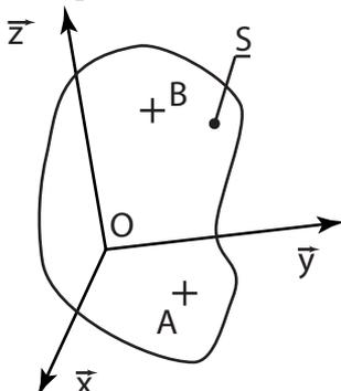
Soient  $\vec{V}(A \in S/\mathcal{R}_0)$  et  $\vec{V}(B \in S/\mathcal{R}_0)$  les vitesses des points  $A$  et  $B$  appartenant à  $S$  par rapport au repère  $\mathcal{R}_0$ .
