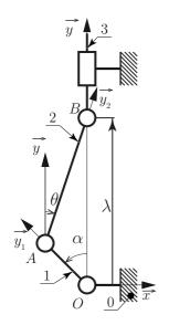
Le mécanisme bielle manivelle permet de transformer une rotation d'angle  $\theta$  en une translation de déplacement  $\lambda$  (OA = a et AB = b).
