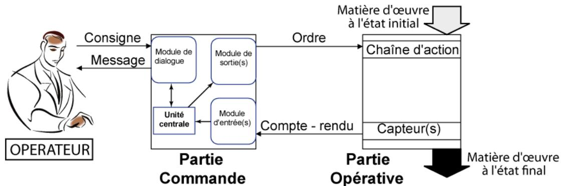
D'une manière générale, un système technique est composé d'une **Partie Opérative (P.O.)** et d'une **Partie Commande (P.C.)** échangeant des informations.
