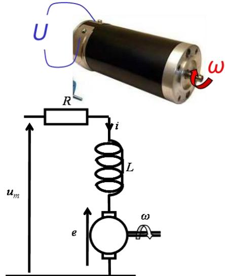
Equation électrique (Circuit RL avec f.c.e.m)
