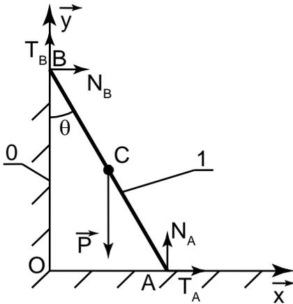
Une échelle, de longueur  $L$ , est soumise à un poids  $\vec{P} = -P.\vec{y}$  en son milieu et à deux forces  $\vec{F}_A = T_A \vec{x} + N_A \vec{y}$  en A et  $\vec{F}_B = N_B \vec{x} + T_B \vec{y}$  en B.
