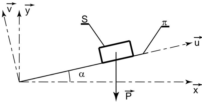
Soit  $S$  un solide parallélépipédique de masse  $M$ , de centre gravité  $G$ , placé sur un plan incliné  $\pi$ , formant un angle  $\alpha$  avec l'horizontale.
